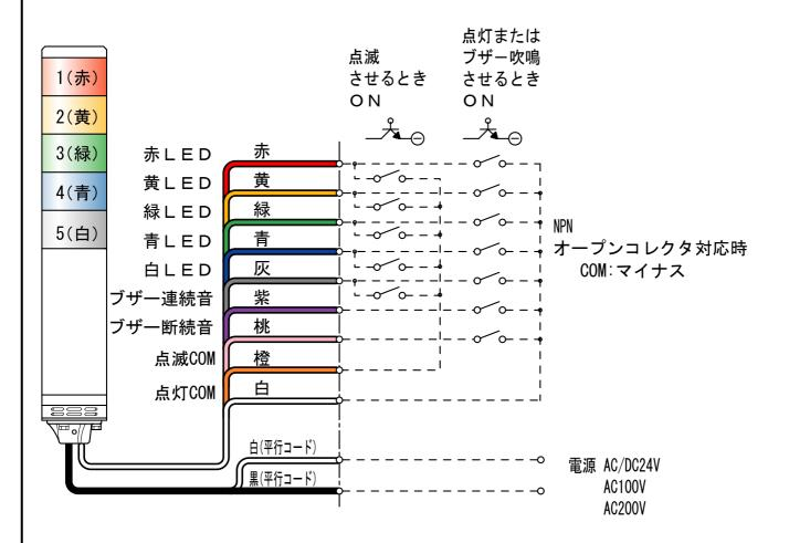
★上記結線例では、点灯点滅同時入力の場合、点灯が優先し、 他の段も点滅できなくなります。また、ブザー連続音・ブザー断続音を 同時入力の場合、ブザー連続音が優先します。
