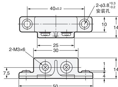
注：端子台部的M3螺钉拧紧时的紧固扭矩为0.59N·m以下。
