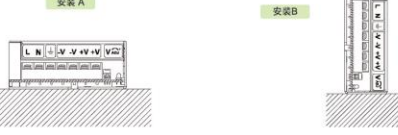
说明 A: 按照铭牌在此标注型号名称, 固定输出电压以及最大输出电流。 B: M3.5螺钉孔位, 客户安装用, 螺钉进入电源内的长度不得大于6mm。
