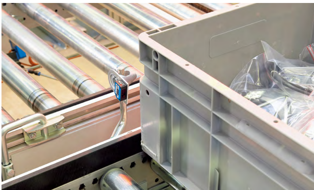
▶ WT100直接反射式光電感測器(背景遮蔽型)可穩定檢測輸送帶上的物件
