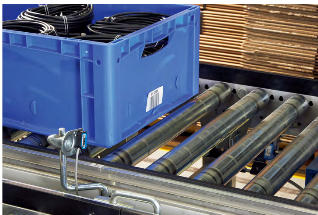
▶ WT8 直接反射式光電感測器 (背景遮蔽型) 可穩定檢測輸送帶上的物件
