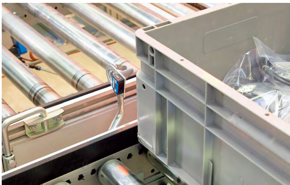
▶ WT8 直接反射式光電感測器 (背景遮蔽型) 可穩定檢測輸送帶上的物件
